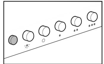
**Extractor fan switch interlocked switching:** Select a fan speed, depress button to turn fan ON. Press button (O) to turn fan OFF.
